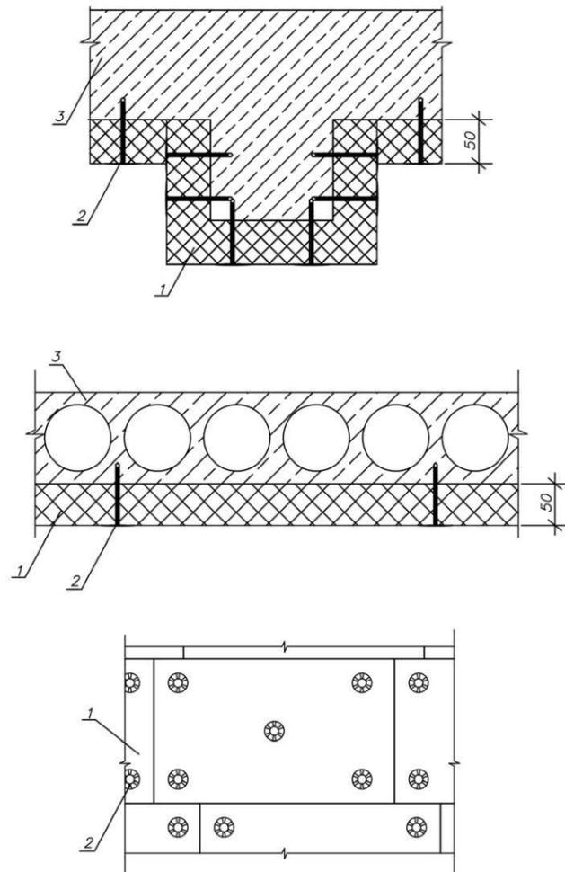
1. Огнезащитная плита PRO-BETON,  $\delta=50$  мм
