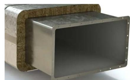
**PRO-VENT** – теплоогнезащитное покрытие, представляющее собой прошивной мат из супертонкого базальтового волокна толщиной 20, 40, 60, 70 мм без добавления связующего. Для выбора обкладки **PRO-VENT** доступны материалы: неармированная фольга, комбинированная обкладка из неармированной фольги и металлической сетки.
