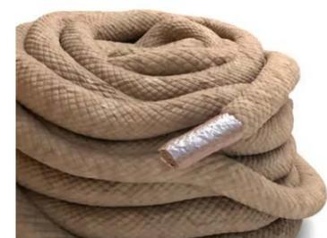
Шнур **BOS-CORD** - шнур базальтовый теплоизоляционный (ШБТ). Используется для уплотнения фланцевых соединений воздуховодов и систем дымоудаления, огнезащиты деформационных швов, теплоизоляции швов технологического и промышленного оборудования, для поглощения вибраций между стыками оборудования.
