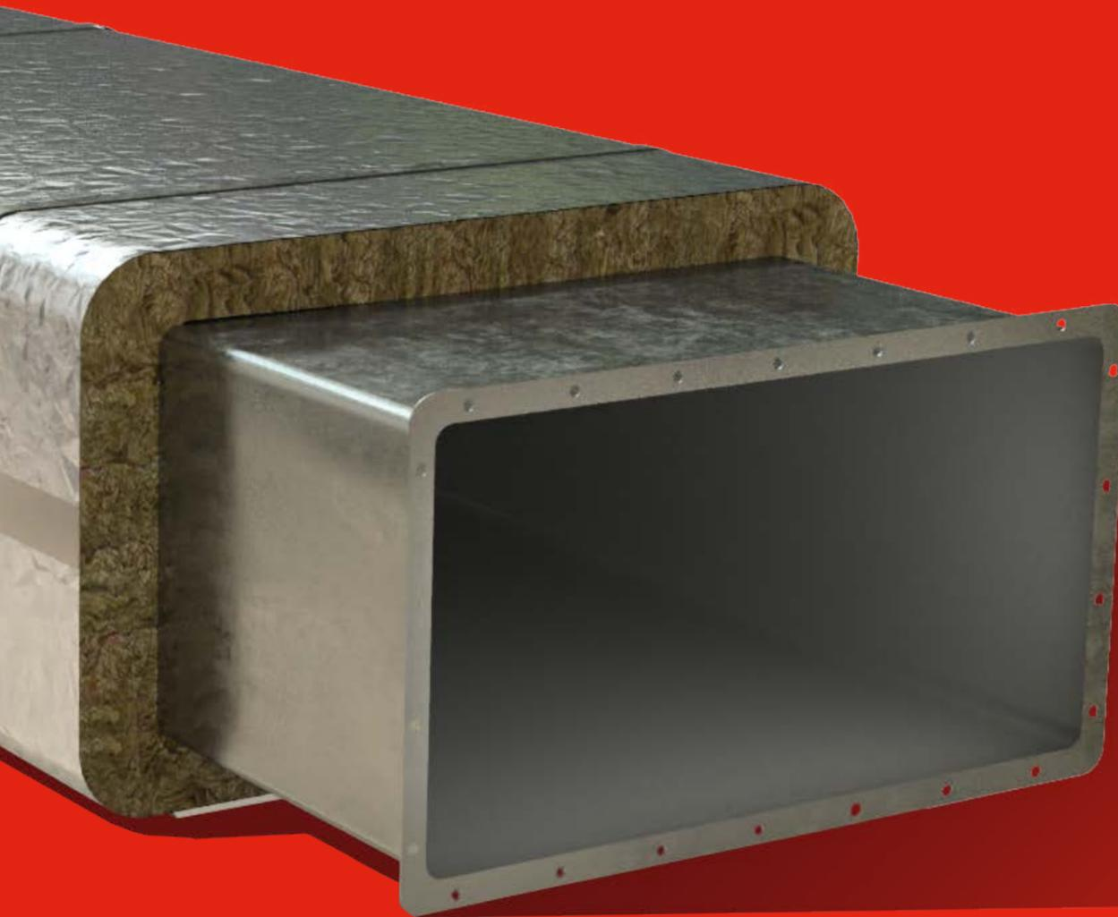
**PRO-VENT** - теплоогнезащитное покрытие, представляет собой прошивной мат из супертонкого базальтового волокна (БСТВ) без добавления связующего.
