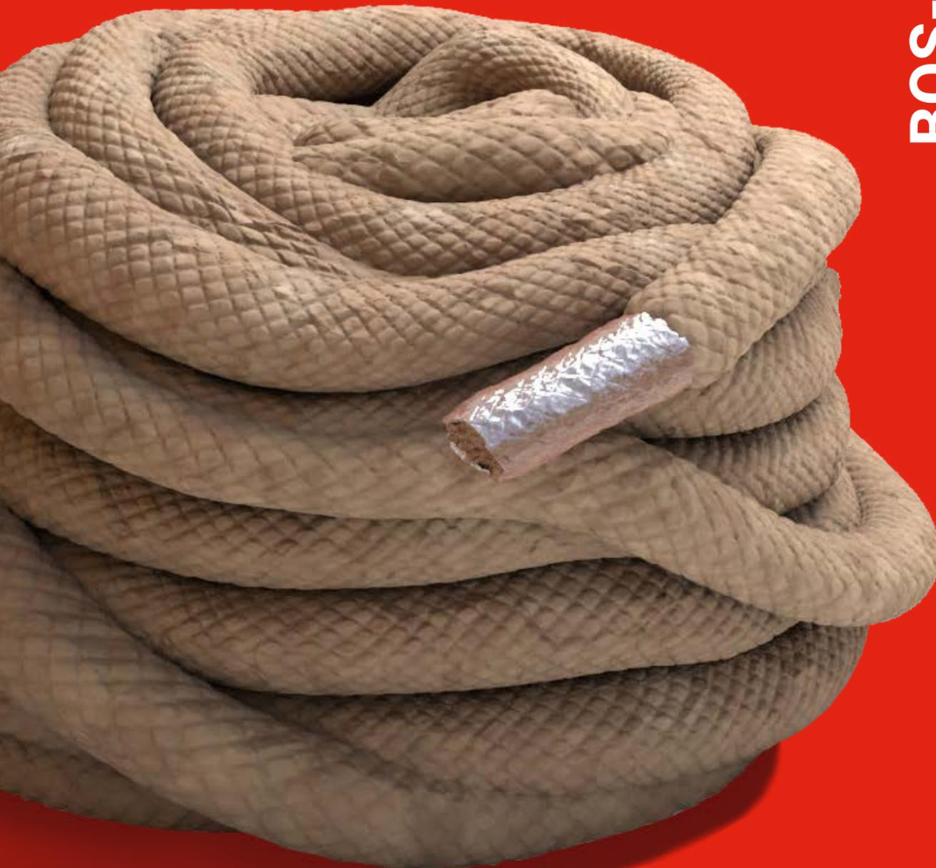
**BOS-CORD** – шнур базальтовый теплоизоляционный производится из чистого базальтового супертонкого волокна, скрученного в жгуты и оплетенного базальтовым ровингом перекрёстным методом. Плотность изделия зависит от частоты плетения ровинга.
